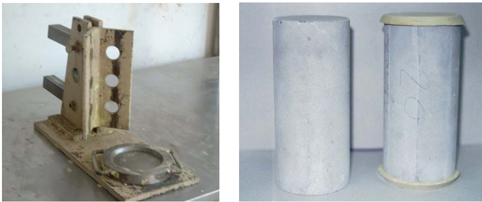
รูปที่ 2 อุปกรณ์เคลือบผิวหน้าคอนกรีต และคอนกรีตที่เคลือบผิวแล้ว
